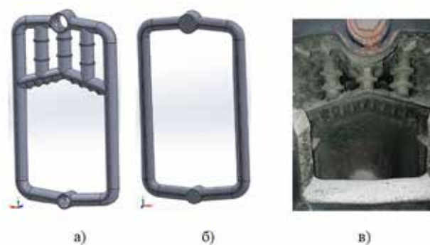
Рис. 1. Модель глибинної і першої секцій (а та б) та фотографія топкової камери діючого пелетного котла VIADRUS A0C (в)
